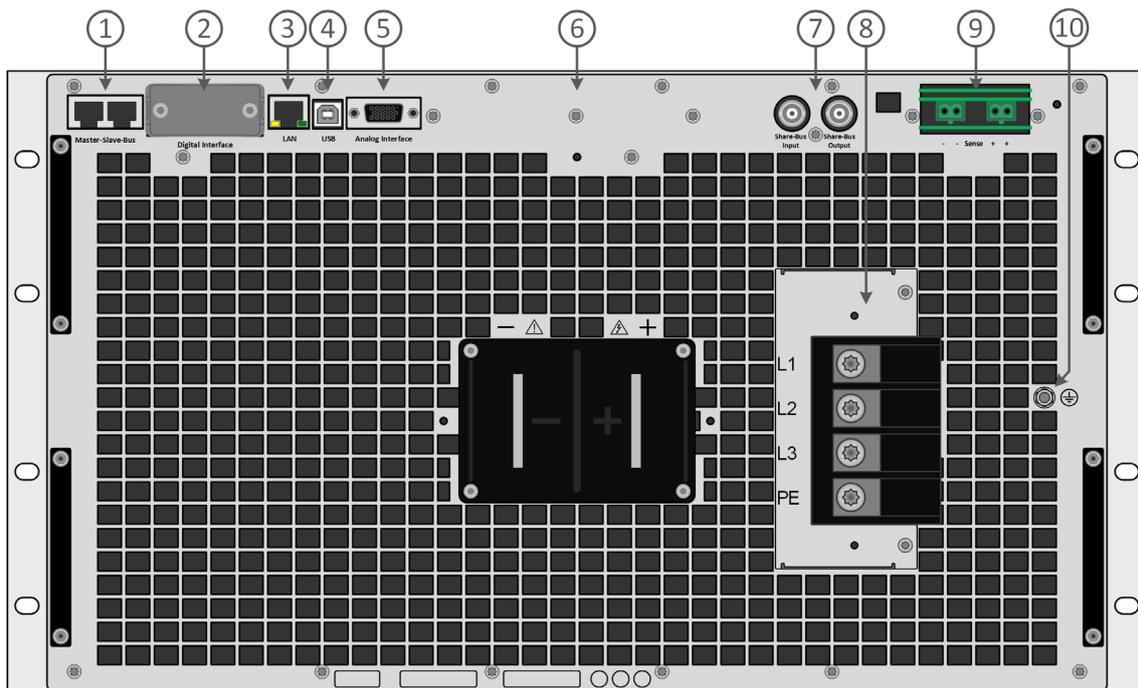
1. Master-Slave-Bus, Anschlüsse zum Einrichten eines Systems für Parallelschaltung
